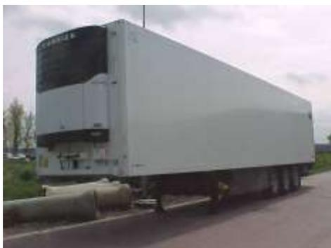
I rimorchi a temperatura controllata non hanno lati telonati flessibili, ma sono completamente circondati da una struttura fissa in metallo o acciaio le cui pareti sono isolate e progettate per trasportare merci a una determinata temperatura. Il rimorchio è dotato di un dispositivo per impostare la temperatura tra + o - 25 °C.
