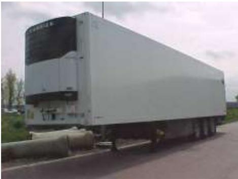
Les remorques isothermes ne sont pas équipées de côtés bâchés flexibles, mais d'une structure rigide métallique ou en acier dont les parois sont isolées et conçues pour transporter des marchandises à une température spécifique. Elles sont équipées de système de régulation de la température allant de plus à moins 25 °C. L'arrimage de la cargaison est limité du fait de la structure du sol et des parois.
