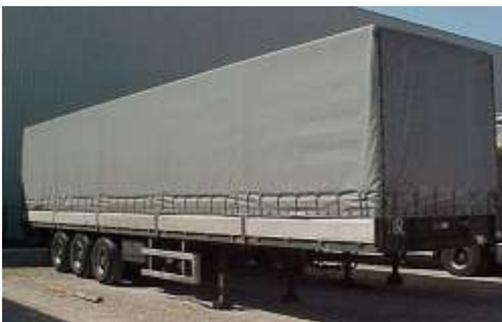
Ce sont des remorques bâchées sur chaque côté, équipées de panneaux latéraux fixés au plancher de la remorque. Ceux-ci peuvent être abaissés de façon à permettre le chargement et le déchargement par les deux côtés ainsi que par l'arrière. Ces remorques ont généralement les dimensions suivantes : longueur de 13,60 m et largeur intérieure de 2,44 m.
