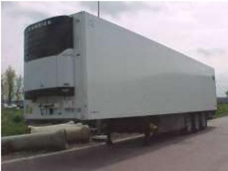
Temperaturregelte Trailer haben keine beweglichen Bordwände. Sie sind aber vollständig von einer metallischen oder Stahlkonstruktion umgeben, wobei die Wände isoliert sind und für den Transport unterhalb einer bestimmten Temperatur vorgesehen sind. Der Trailer ist mit einem Aggregat ausgestattet, mit dem die Temperatur zwischen Plus- und Minus-25 °C eingestellt werden kann.
