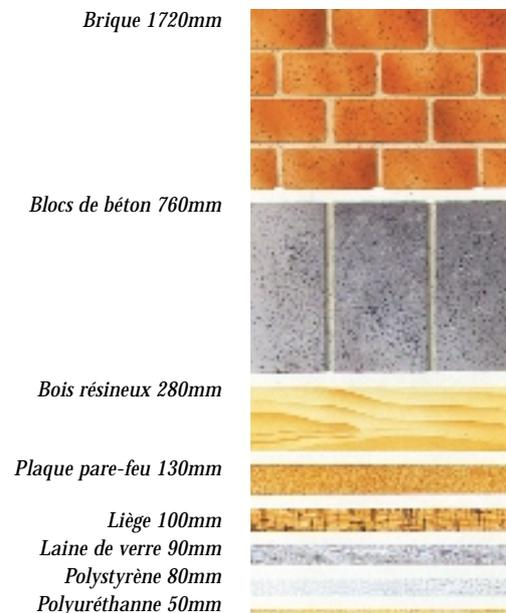
*Fig.1. Epaisseurs thermiquement équivalentes à une mousse PU de 50mm pour différents matériaux.*
