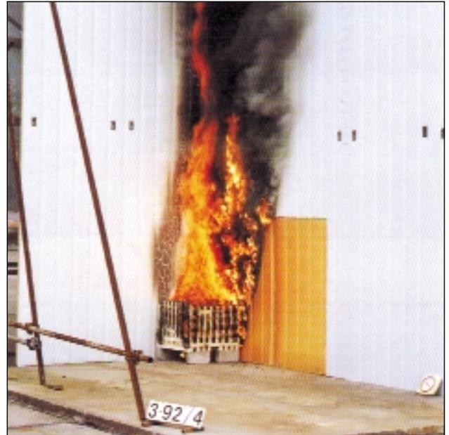
*Mise à nu latérale de la mousse : contribution à la propagation du feu dans l'essai en coin.*
