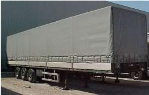
Los remolques abatibles cuentan con lonas en ambos lados y paredes laterales fijadas a la estructura del suelo que pueden abatirse para cargar y descargar mercancía tanto por los lados como por la parte trasera. Las dimensiones son generalmente: 13,60 m de largo y 2,44 m de ancho interior.
