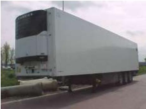
Los remolques con temperatura controlada no tienen laterales flexibles de lona sino que están totalmente cubiertos por una estructura fija de acero u otro metal con paredes aislantes. Están diseñados para transportar mercancías a una temperatura determinada. El remolque lleva adosada una unidad que permite configurar la temperatura en un rango de
